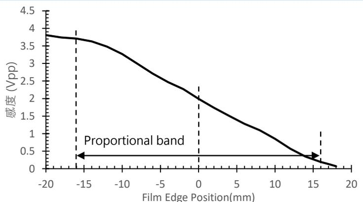
如上圖所示A170W2在工作區間(28 mm,即 $\pm 14$  mm)· 傳感器的訊號感度與薄片邊緣移動位置具有良好的線性相關特性· 可以提供精準的糾偏偵測
