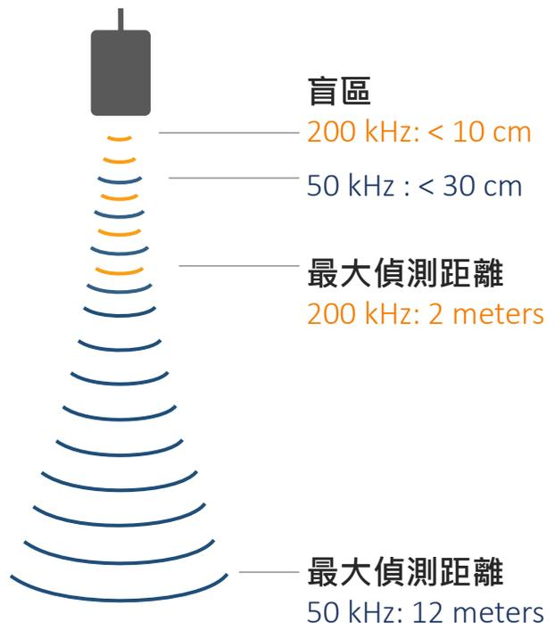
Y050A1是一種新型雙頻超音波空氣傳感器，為一訊號發送與接收於一體的超音波傳感器。在 50 kHz 操作模式下偵測距離可達 12公尺，而在 200 kHz 操作模式下盲區只有 10 cm。該超音波傳感器特別適用於非接觸式位高偵測和距離偵測，具有高解析度、偵測距離長、盲區短以及卓越的可靠性等優點。
