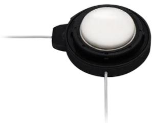
**A500B1** 超音波傳感器採用詠業科技自製的壓電陶瓷和自有專利的聲匹配層及結構設計，可作為超音波訊號發送與接收一體使用。該超音波傳感器適用於氣體流量檢測，具有高度的穩定性與可靠度，對於流量檢測有出色的穩定度表現，其耐腐蝕的設計特別適用於燃氣表的流量偵測。
